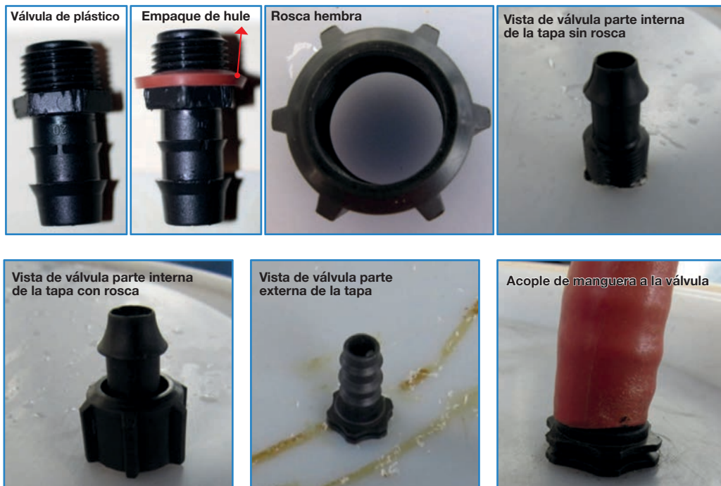
Figura 35. Diagramas de las piezas usadas en la conexión que se realiza de la manguera a través de la tapa y hasta la botella, para asegurarse la condición anaeróbica.
